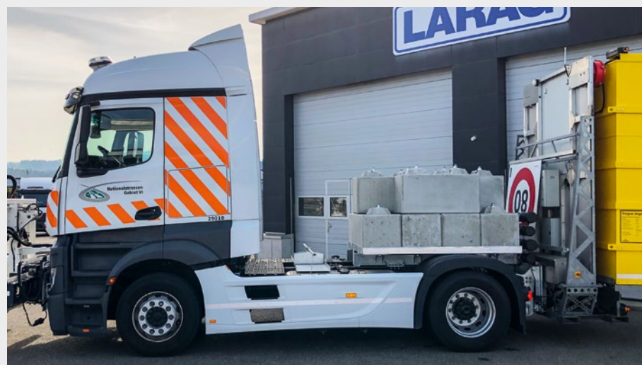
SwissBlock®-TEC kraftschlüssig mit Fahrgestell verschraubt
