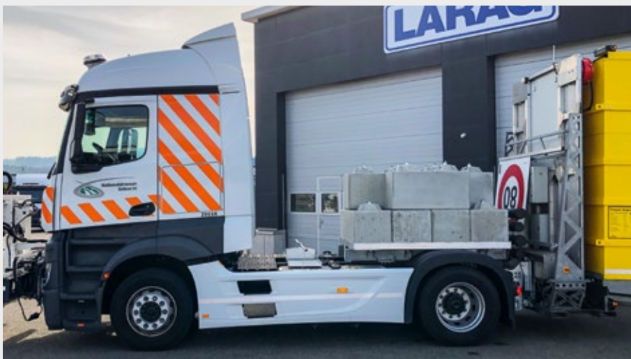
SwissBlock®-TEC kraftschlüssig mit Fahrgestell verschraubt.
